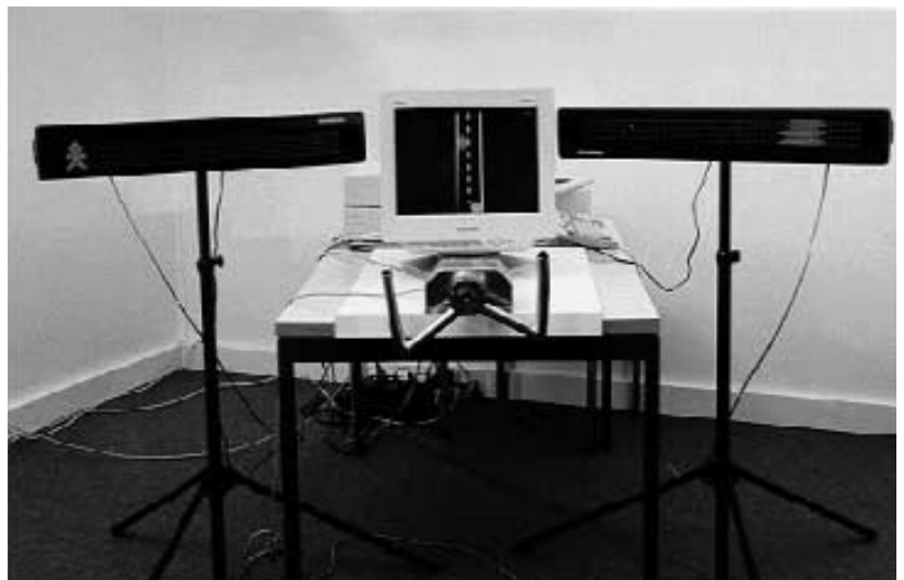
Abb. 1: Die PC-gestützte Schweizerische Verkehrspsychologische Normaluntersuchung SVN'96 – mit dieser Testbatterie klären Gutachtende ab, wie es um die Vigilanzleistung, die Auffassungskapazität bei geteilter Aufmerksamkeit und die sicherheitsbezogene Verhaltenssteuerung der FahrerInnen bestellt ist. Foto: Urs Gerhard.
